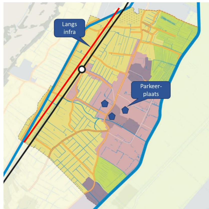
Figuur 21: Ruimte zonnepanelen langs infrastructuur
